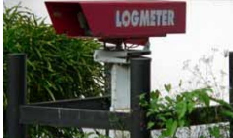
Logmeter: sistema para cubicar la carga de camiones forestales
