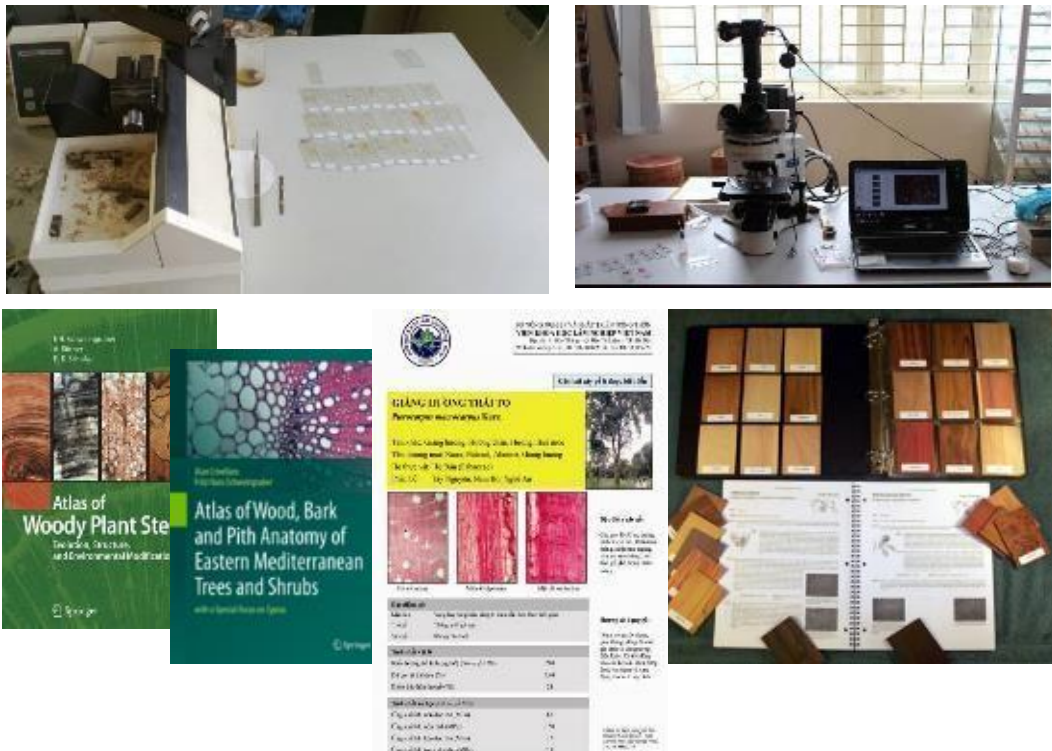
Hình 28: Mẫu gỗ được cắt lát mỏng, mô tả các đặc điểm cấu tạo thô đại và hiển vi trên kính hiển vi
