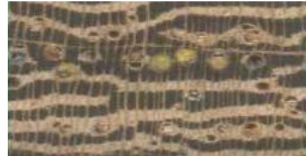
Hình 37: Chất chứa trong mạch gỗ (Millettia stuhlmannii)
